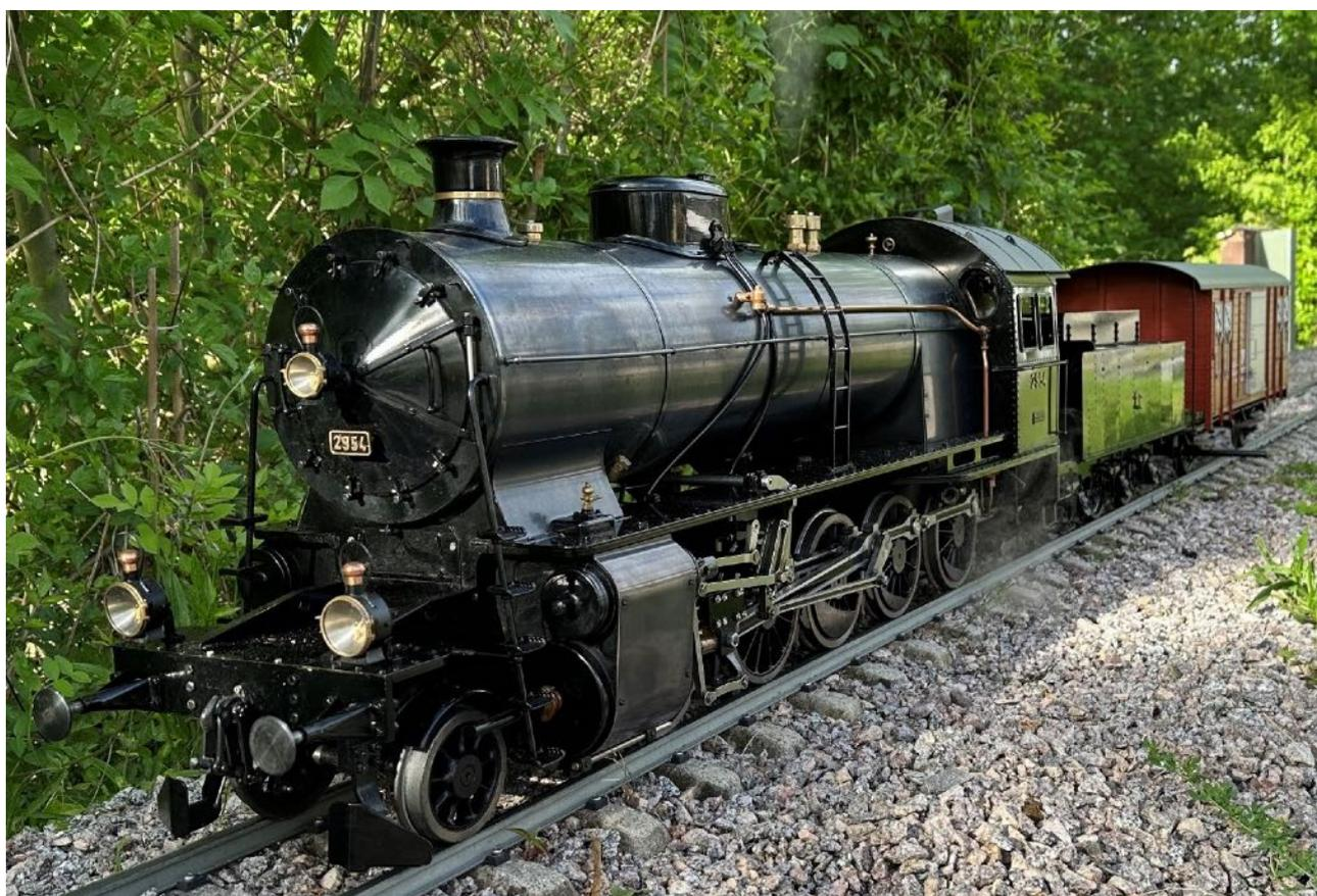
C 5/6 a 4 cilindri (alta e bassa pressione) con il vagone K3 costruito da Leni Imhof
