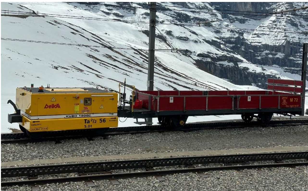
Trattore "CUBO" radiocomandato costruito dalla Belloli di Grono
