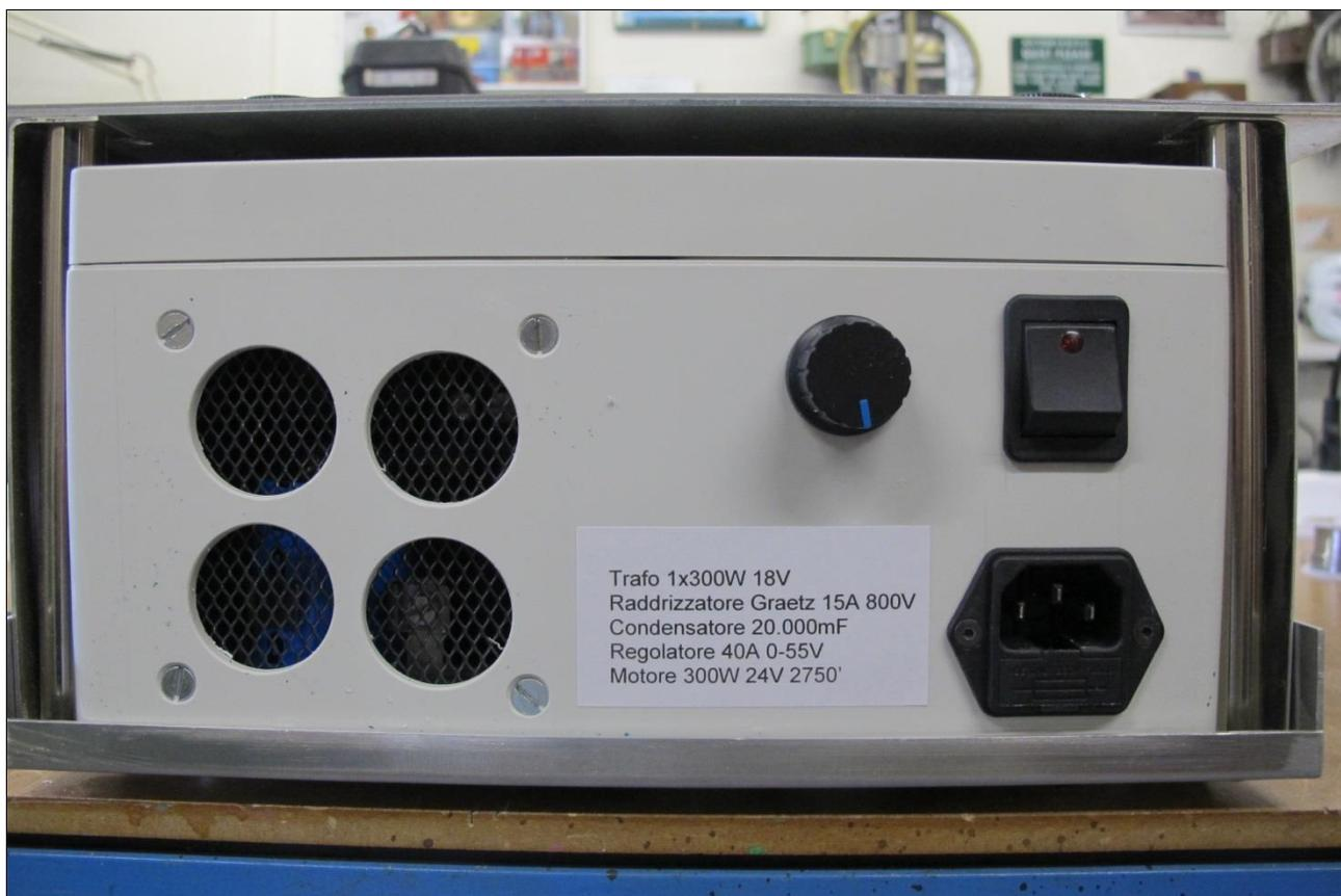
alimentatore 24V 12A montato
