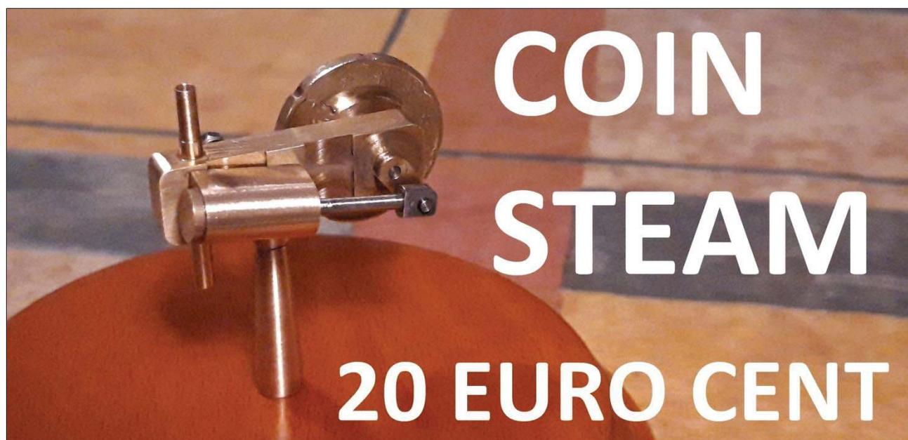
E così in una settimana o poco più ho costruito i miei due modellini il cui buon funzionamento è stato più che soddisfacente; il modello gira con una pressione di 0,1 bar forse anche meno ma è difficile misurarla con precisione.
