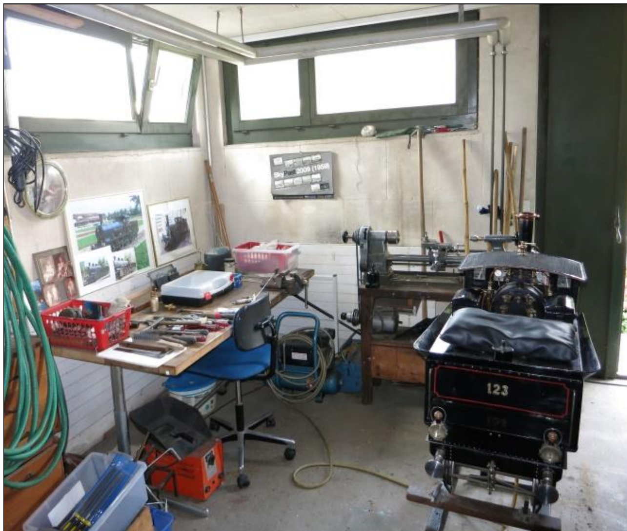
L'officina con il tornio usato come fresatrice
