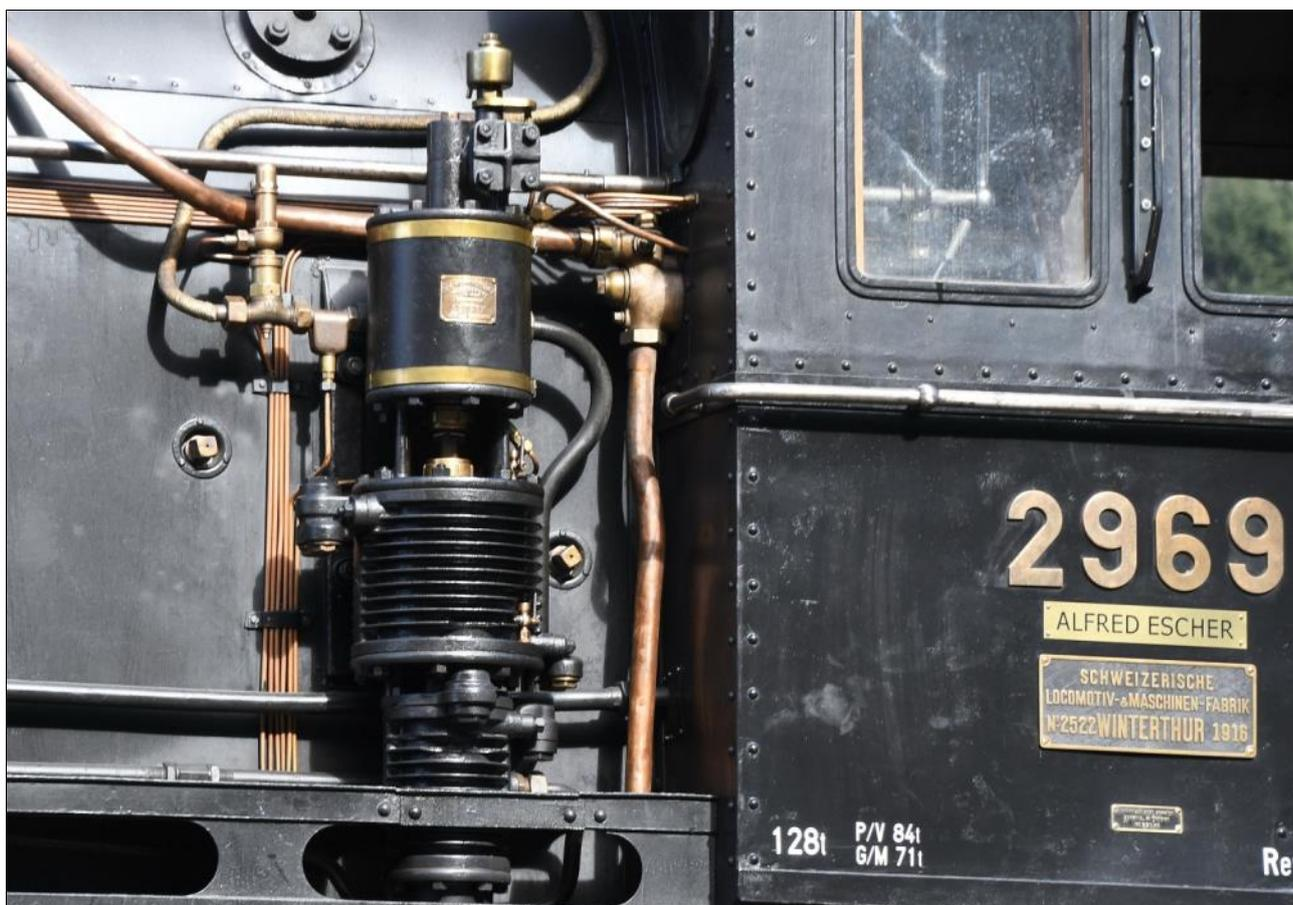
Bodio 22.03.2018 – Pompa ad aria Westinghouse e dati della C5/6 costruita dalla SLM nel 1916
