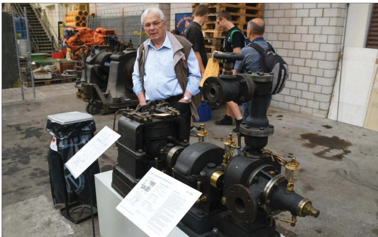
Turbina Laval (5 bar 30'000 g/min) con generatore 110V 29A
